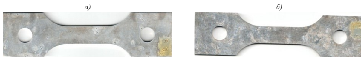
Рис. 1. Общий вид образцов из сплавов 1441 (а) и В-1469 (б) после 10 сут выдержки
