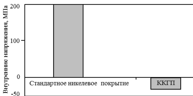
Рис. 5. Остаточные внутренние напряжения в никелевых покрытиях толщиной 40 мкм (ККГП – композиционно-кластерное гальваническое покрытие)
