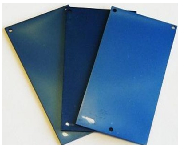
Рис. 3. Внешний вид покрытий, уплотненных в разработанном растворе
