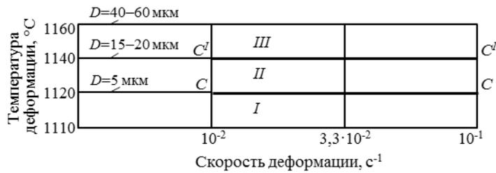
Рис. 2. Структурная диаграмма сплава ВЖ175 с областями без рекристаллизации (I), с частичной (II) и полной рекристаллизацией (III); C–C и C<sup>l</sup>–C<sup>l</sup> – границы между областями; D – размер зерна
