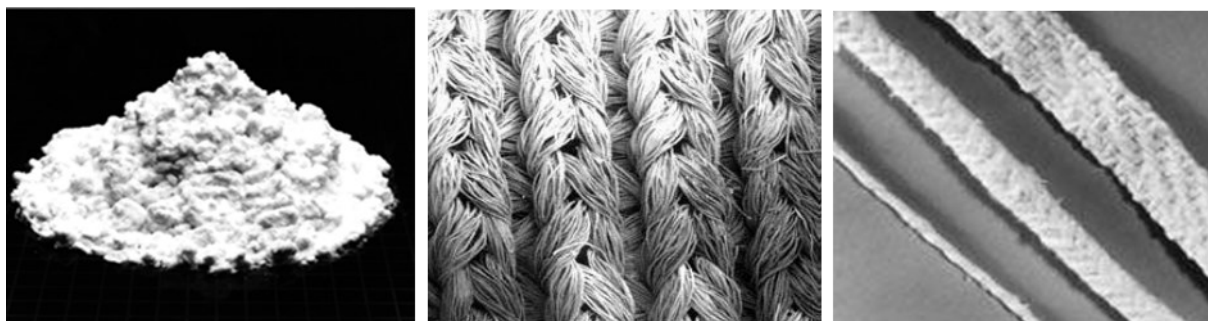
Рис. 1. Волокна оксида циркония (фото СЭМ) компании Zircar Zirconia Inc.
