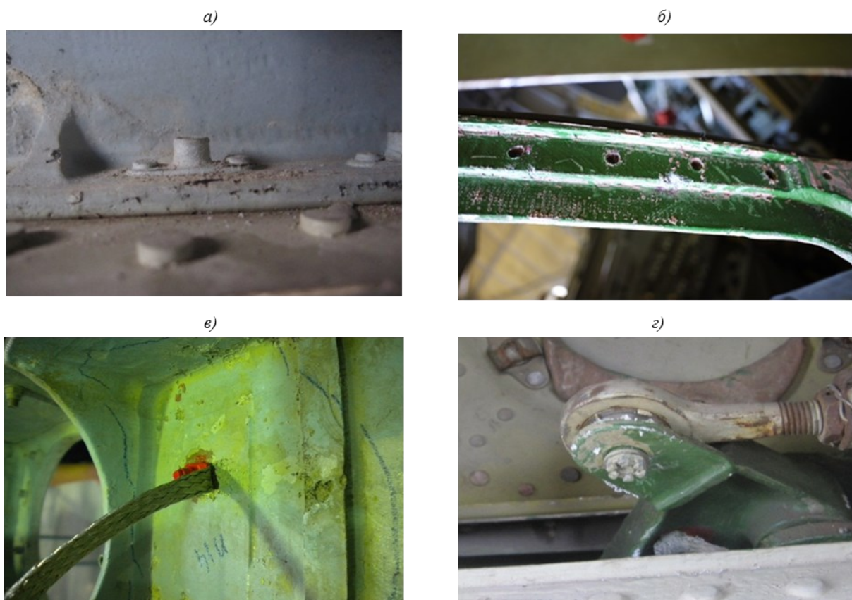
Рис. 1. Детали из магниевых сплавов после 10 лет эксплуатации в условиях приморской атмосферы умеренно теплого климата:
