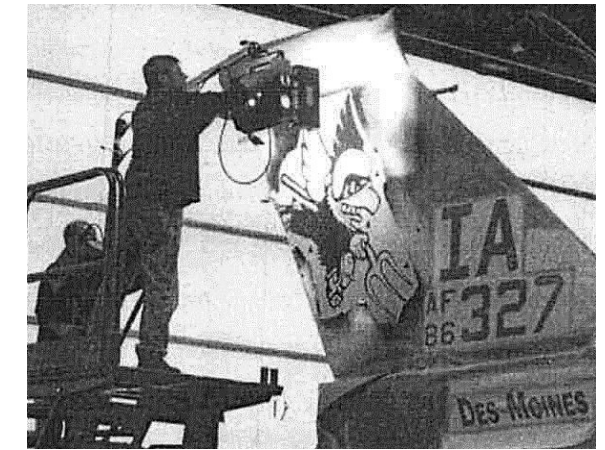
Рис. 2. Процесс УФ-отверждения маркировочных знаков самолета с использованием небольшой УФ-панели
