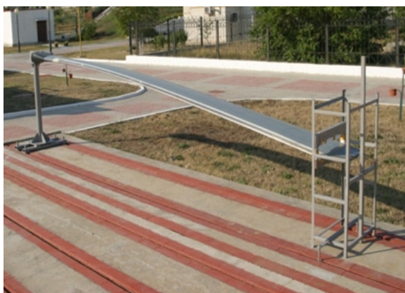
Рис. 1. Климатические испытания лопасти несущего винта вертолета Ми-28Н
