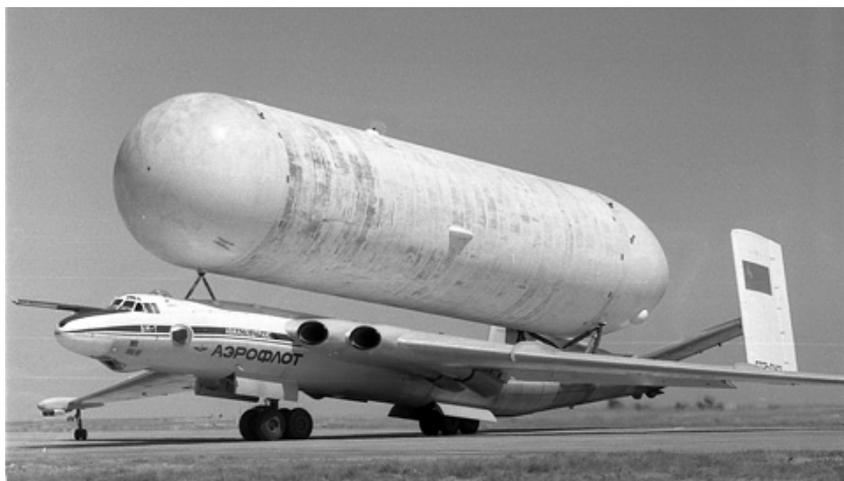
Рис. 3. Топливный бак из сплава 1201 на транспортном самолете КБ им. В.М. Мясищева
