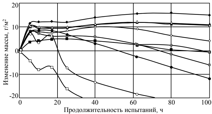
Рис. 2. Зависимости изменения удельной массы образцов при температуре испытаний 1200°C в течение 100 ч из сплава 2 с различными покрытиями:
