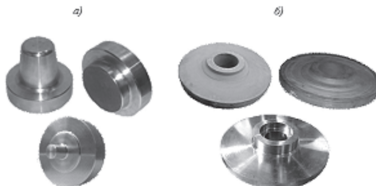
Рис. 2. Штамповки из сплава ВЖ175-ИД массой 15 (а) и до 180 кг (б)
