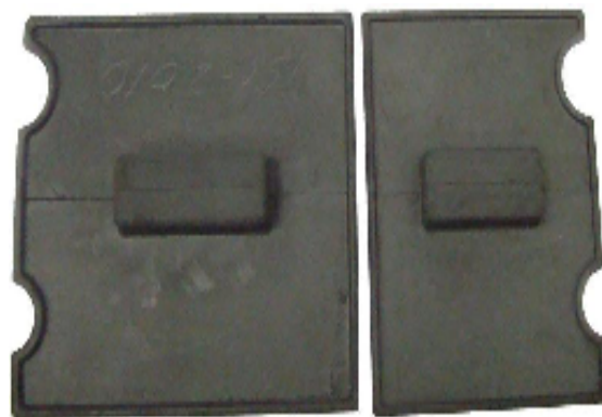
Рис. 1. Деталь «Экран» из композиционного материала системы SiC–SiC (ВИАМ)
