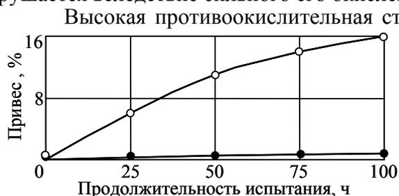
Рис. 1. Жаростойкость (при  $1100^{\circ}\text{C}$ ) образцов износостойкого уплотнительного материала системы  $\text{Fe}(\text{Ni})\text{-Cr-Al-Y}$  с тонкопленочным покрытием (●) и без покрытия (○)
