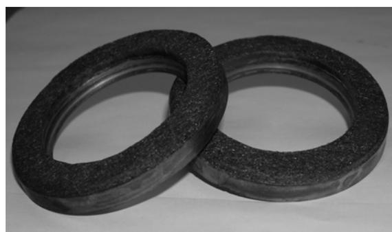
Рис. 3. Внешний вид образцов пористого износостойкого материала с тонкопленочным покрытием
