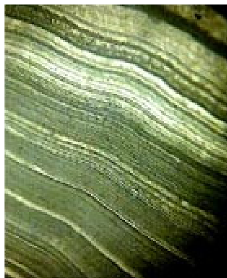
Рис. 2. Микрошлиф пиролитического карбидохромового покрытия (ПКХП) ( \times 500 )
