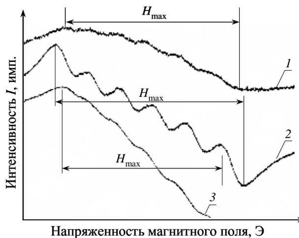
Рис. 4. Спектры ЭПР от ионов  $Mn^{2+}$  ( $H_{\max}$  – общая ширина суммарных линий ЭПР) в кальцинированных при  $700^{\circ}C$  образцах гелей с SrO+CaO (1), SrO (2), CaO (3)
