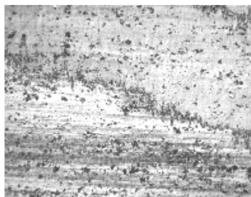
Рис. 2. Микроструктура ( \times 50 ) листов (толщина 1,5 мм) из сплава В-1469-Т1
