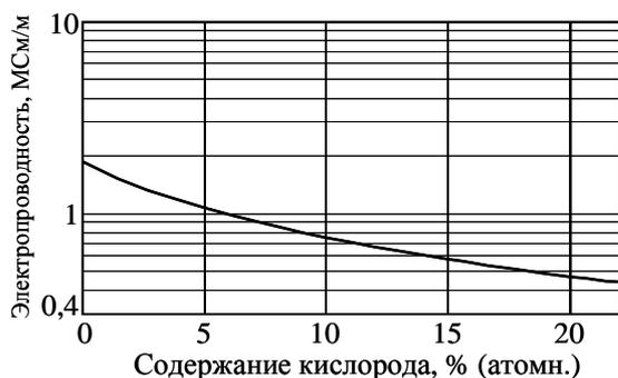
Рис. 1. Зависимость электропроводности от содержания кислорода в титане
