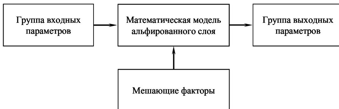
Рис. 3. Абстрагированная математическая модель приповерхностной области титанового сплава с альфированным слоем с учетом принципов моделирования «черного ящика» с указанными направлениями входных и выходных параметров
