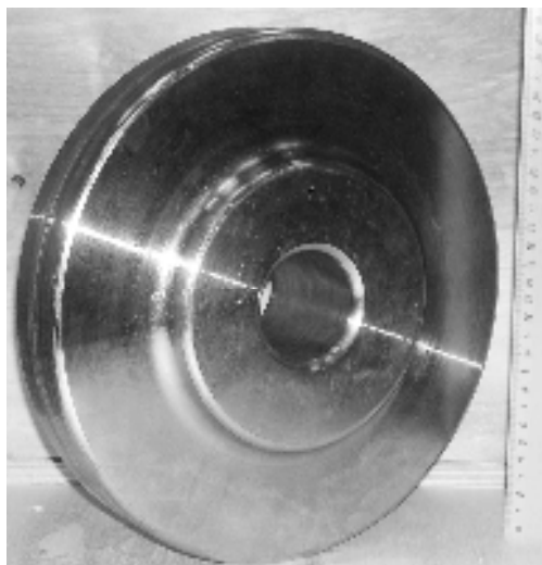
Рис. 9. Штамповки дисков ТВД для малоразмерных ГТД (максимальный \varnothing 280 мм)
