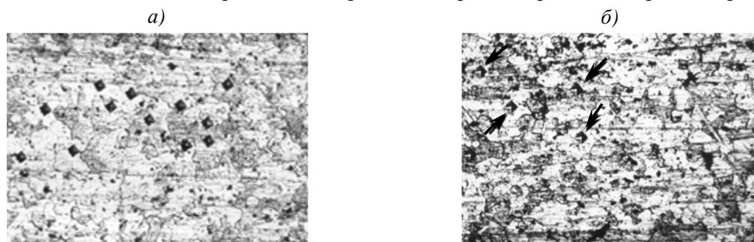
Рис. 9. Распределение микротвердости (стрелками показаны отпечатки от твердомера) по зернам в материале АЛОП ( $\times 320$ ):
