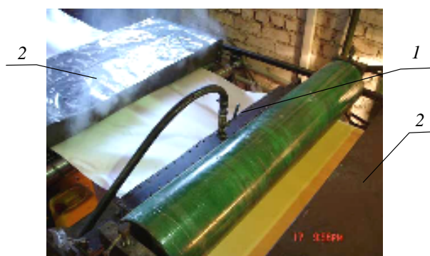
Рис. 2. Узел пропитки установки УПР-3:
