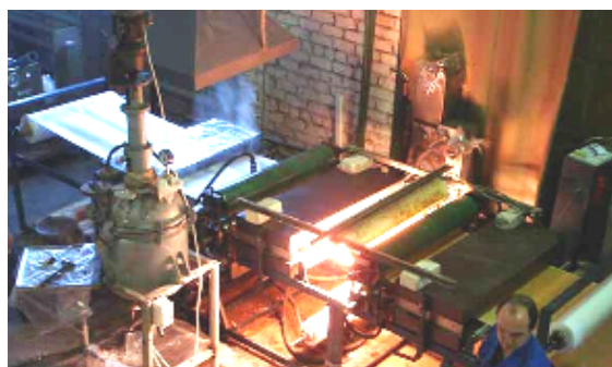
Рис. 3. Общий вид установки УПР-3 с фильерой и устройством инфракрасного нагрева
