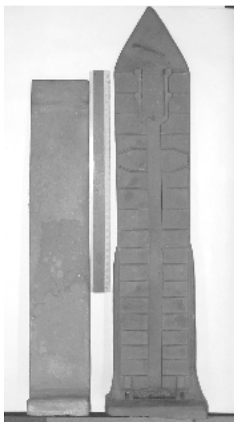
Рис. 7. Заготовка пластины для фильер с направленной структурой и створка реактивного сопла с управляемым вектором тяги из интерметаллидного сплава ВКНА-1В с монокристаллической структурой
