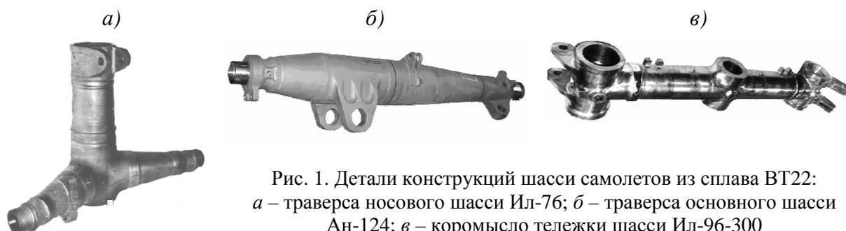
Рис. 1. Детали конструкций шасси самолетов из сплава ВТ22:
