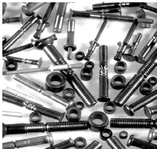
Рис. 3. Детали крепления из сплава ВТ16, изготовленные методом холодного деформирования
