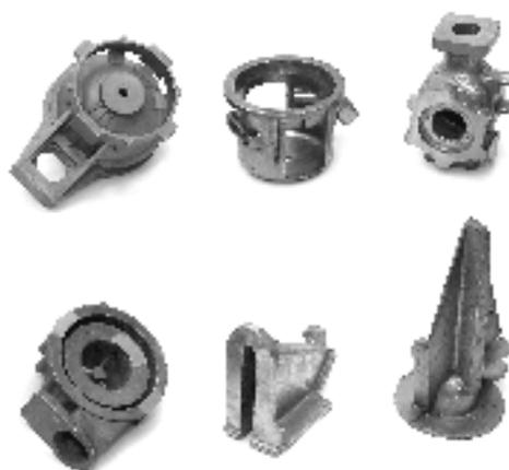
Рис. 9. Отливки из сплава ВТ40Л
