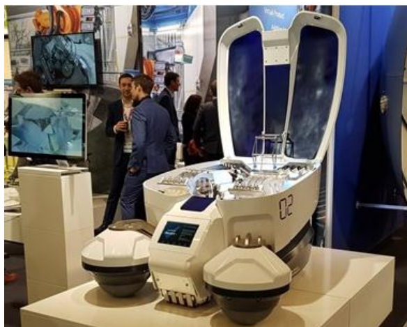
Робот Flarrybot для автоматизированной выкладки препрега [25]
