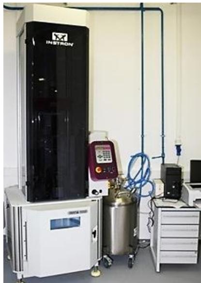
Рис. 2. Вертикальный копер Ceast 9350 компании Instron
