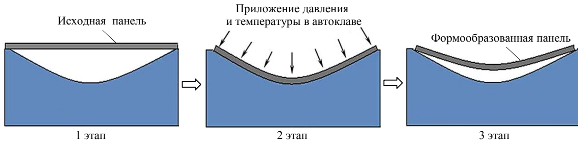
Рис. 1. Изменение формы панели обшивки в процессе автоклавного формования
