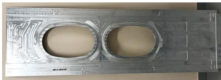
Рис. 5. Фрагмент нижней панели крыла из плиты сплава 1441 после отработки технологии автоклавного формования
