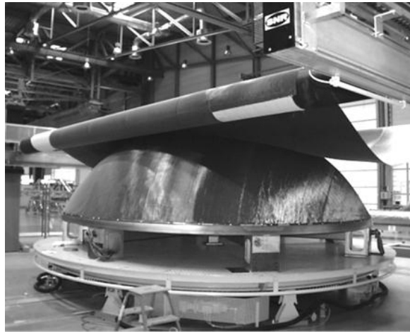
Рис. 6. Размещение преформы из мультиаксиальной углеродной ткани на оснастке при изготовлении заднего гермошпангоута самолета A380 [9]
