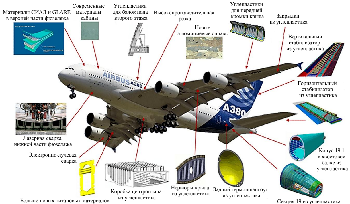
Рис. 1. Элементы конструкции самолета Airbus A380, выполненные из композиционных материалов [2]
