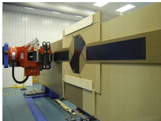
Рис. 2. Пример установки ATL на вертикальной раме для выкладки ленты шириной 300 мм [6]
