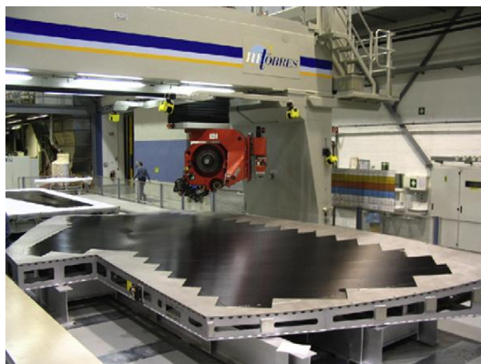
Рис. 1. Пример установки ATL на горизонтальной раме [10]
