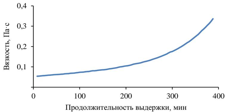
Рис. 3. Зависимость вязкости связующего ВСЭ-62 (20 дней хранения при температуре 25 °С) от времени изотермической выдержки при температуре 100 °С
