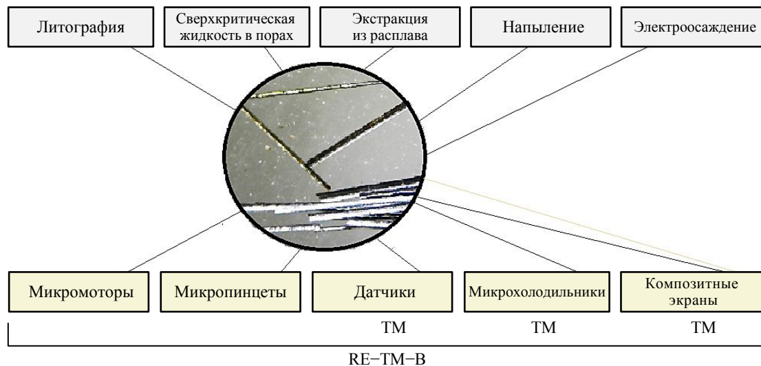
Рис. 1. Технологии изготовления и области применения микропроводов на основе сплавов RE–TM–B и TM (показаны области применения, перекрываемые этими сплавами)
