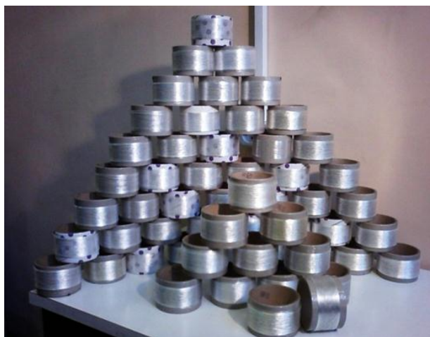
Рис. 7. Паковки многофиламентной нити из волокон оксида алюминия
