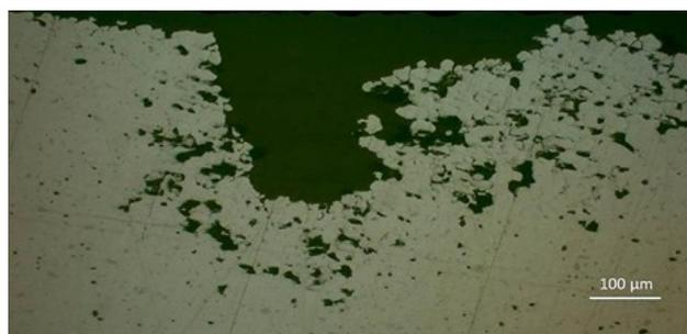
Рис. 6. Результат металлографического анализа образца из алюминиевого сплава после проведения комбинированного анодного растворения по режиму 1/2
