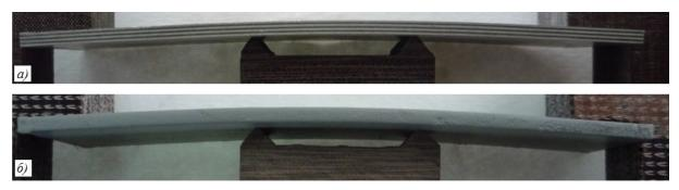
Рис. 9. Торцы образцов из материала СИАЛ-3-1 при испытаниях на четырехточечный изгиб: a — без покрытия;  $\delta$  — с покрытием «грунт+ЛКП»
