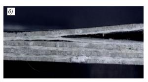
Рис. 7. Макроснимки ( $\times$ 25) образцов из материала СИАЛ-3-1 размером 60 $\times$ 60 мм с угловым непроклеем после 1 года экспозиции на открытой площадке (a) и в камере солевого тумана ( $\delta$ )
