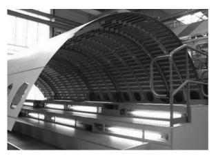
Рис. 3. Верхняя обшивка фюзеляжа самолета A-380 из материала GLARE [3]
