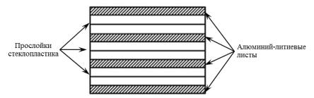
Рис. 1. Схема укладки слоев в материале СИАЛ-3-1
