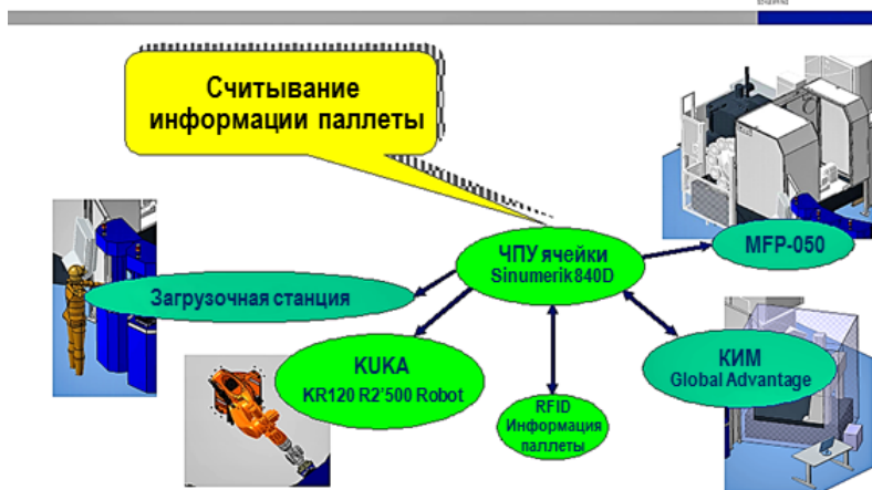
Рис. 11. Фрагмент цикла работы роботизированной ячейки
