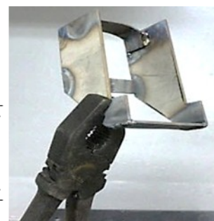
Рис. 1. Чертеж поворотной рамки (1 – подставка; 2 – пластина; 3 – образец) и рамка после сварки
