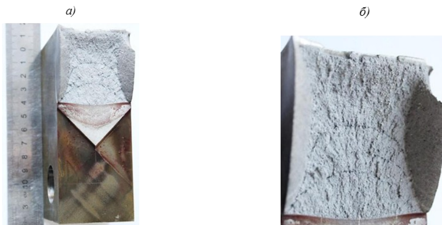
Рис. 7. Характер разрушения образца из стали 20ХГСН2МФА-ВД толщиной 50 мм: а – общий вид разрушенного образца; б – скачкообразное развитие трещины в образце
