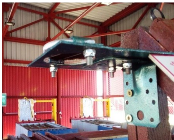
Рис. 3. Экспозиция сульфатной чашки для определения количества диоксида серы в атмосфере
