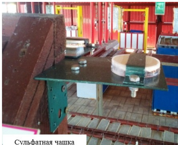
Рис. 3. Экспозиция сульфатной чашки для определения количества диоксида серы в атмосфере
