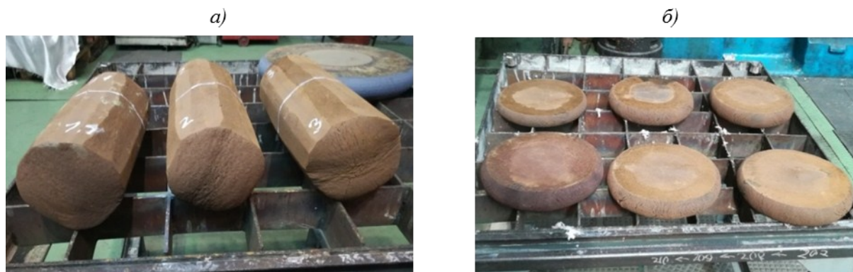
Рис. 1. Полуфабрикаты из сплава VT22M после проведенияковки (а) и штамповки (б)
