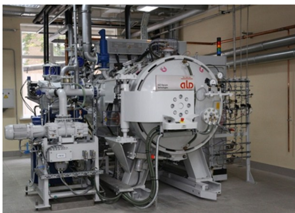
Рис. 3. Установка для вакуумной термической обработки MonoTherm
