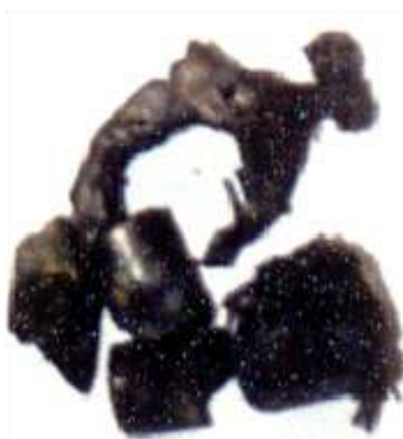
Фрагмент сердечника пули Б-32 после ее взаимодействия с керамической преградой
