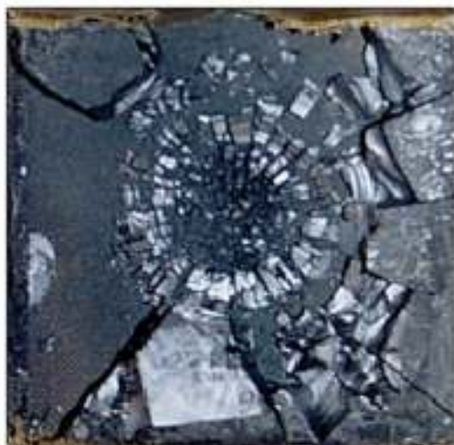
Непробитие бронезлемента с экраном из керамической плитки после воздействия пули типа Б-32, выпущенной из винтовки СВД
