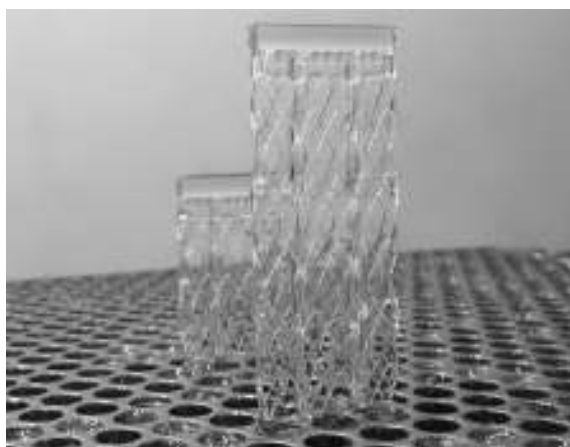
Рис. 4. Тест-объекты из ФПК ИПЛИТ-4 на поддерживающих структурах, выращенных при трехкратном сканировании и без превышения суммарной экспозиционной дозы отверждения слоя при каждом сканировании
