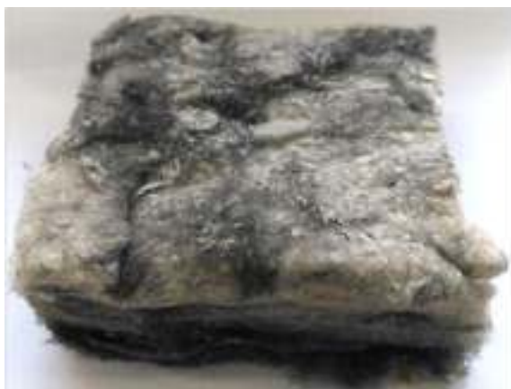
Рис. 1. Образец гибкого теплозащитного волокнистого материала на основе смеси неорганических волокон и волокон растительного происхождения
