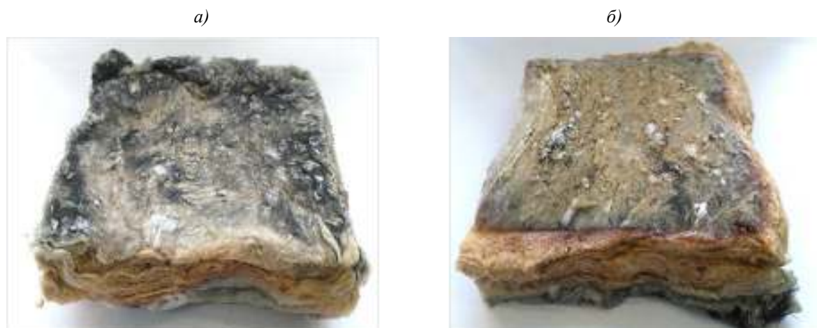
Рис. 2. Образцы гибкого волокнистого материала на основе смеси неорганических волокон и волокон растительного происхождения после одностороннего воздействия температуры 1200°C с «горячей» (а) и «холодной» сторон (б)
