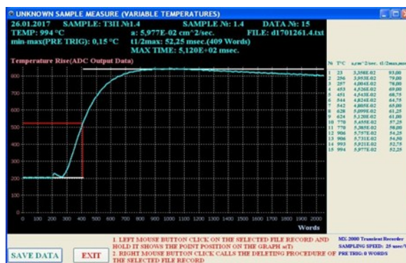
Рис. 7. Кривая изменения температуры на задней поверхности двухслойного образца «керамический слой YSZ+подложка из нихрома ЭИ435», измеренная оптическим датчиком после облучения лазерной вспышкой при температуре 994^\circ C
