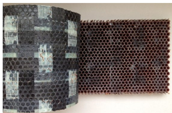
Рис. 4. Фотография испытанного образца на усилие отслаивания обшивки на барабане
