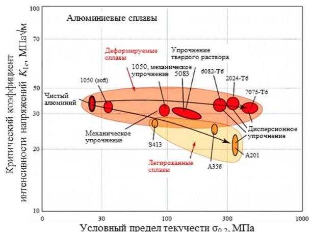
Рис. 7. Диаграмма соотношения характеристик прочности алюминиевых сплавов
