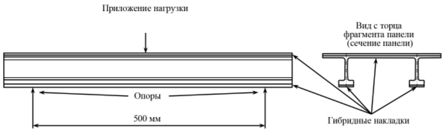
Рис. 9. Схема нагружения конструктивно-подобного образца верхней сварной гибридной панели крыла на трехточечный изгиб
