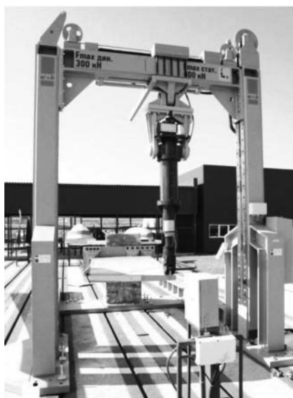
Рис. 1. Вертикальный стенд для испытаний крупногабаритных конструкций с максимальным усилием 25 тс
