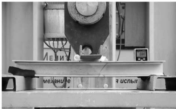
Рис. 10. Внешний вид конструктивно-подобного образца верхней сварной гибридной панели крыла, установленной на испытательный стенд
