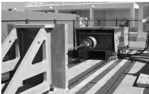
Рис. 2. Горизонтальный стенд для испытаний крупногабаритных конструкций с максимальным усилием 100 тс
