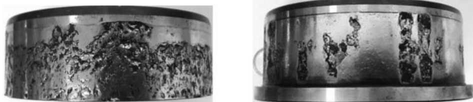
Рис. 9. Внешний вид внутренних колец качения
