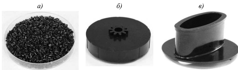
Рис. 2. Гранулы материала марки ВТП-7 (а) и детали (б, в), изготовленные из него методом литья под давлением
