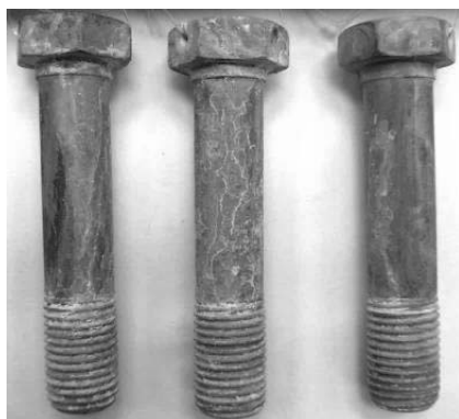
Рис. 5. Внешний вид стальных болтов с резьбой М12, покрытых четырехслойным гальванотермическим покрытием с оптимальной термообработкой, после 8000 ч экспозиции в КСТ
