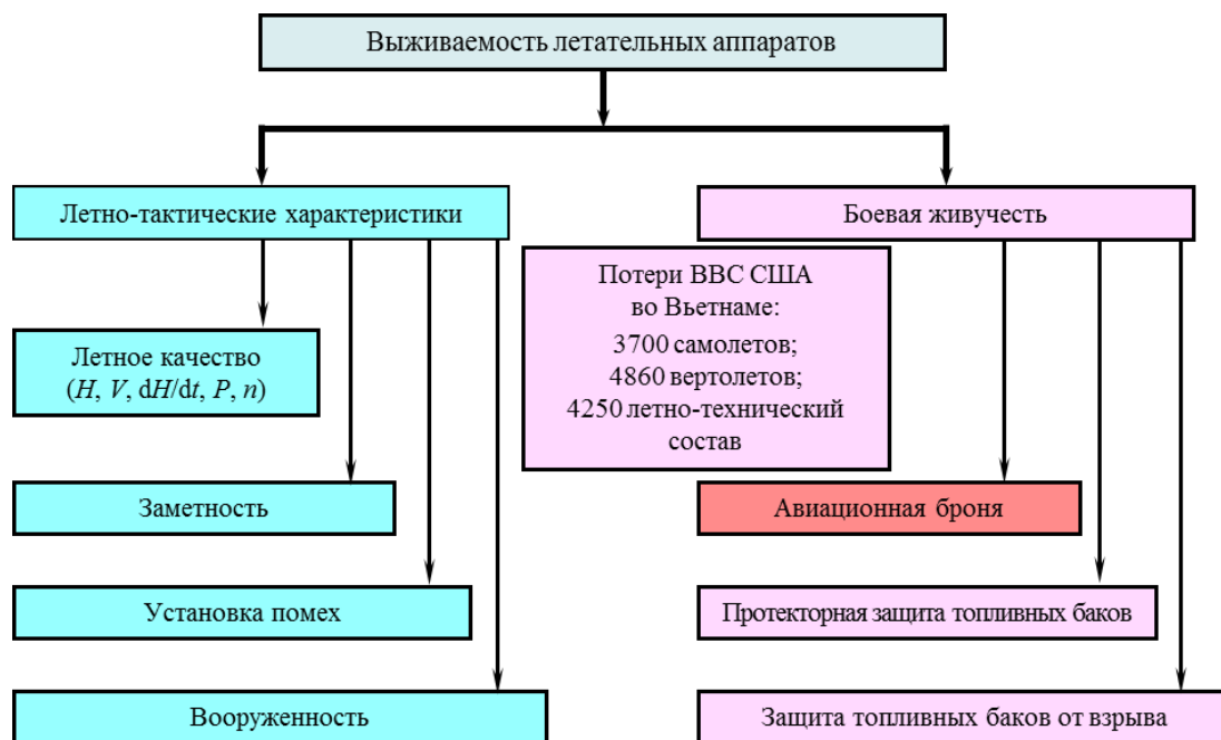
Рис. 1. Факторы, определяющие боевую живучесть летательных аппаратов, и потери военно-воздушных сил (ВВС) США во Вьетнаме ( H – высота полета, V – скорость, dH/dt – скорость набора высоты, P – энерговооруженность, n – перегрузки)
