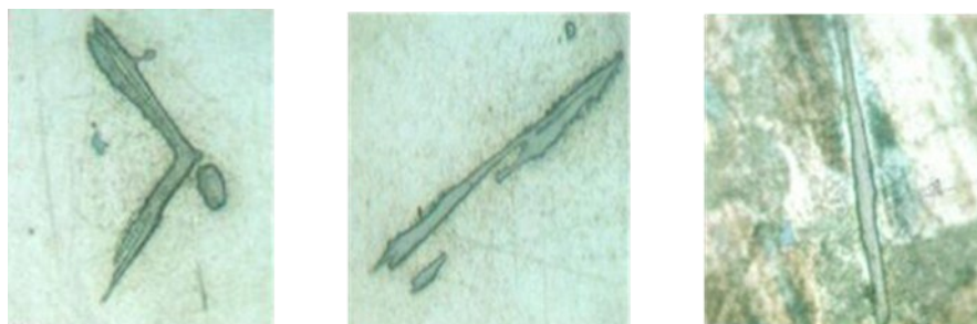
Рис. 5. Фаза Mg 2 Si в промышленной плавке сплава МЛ5п.ч.-Т6 (×500)
