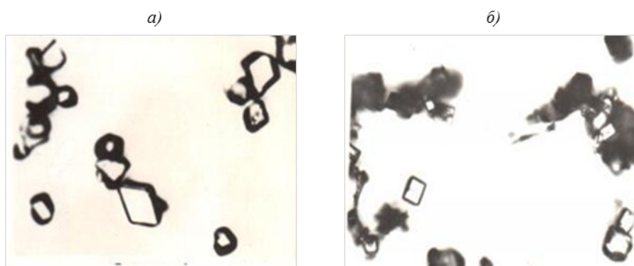
Рис. 4. Фазы \eta -Mn 5 Al 8 (а) и \tau -MnAl (б), изолированные из сплава МЛ5п.ч.
